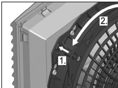
Fig. 5: Déverrouillage de la fermeture à baïonnette
