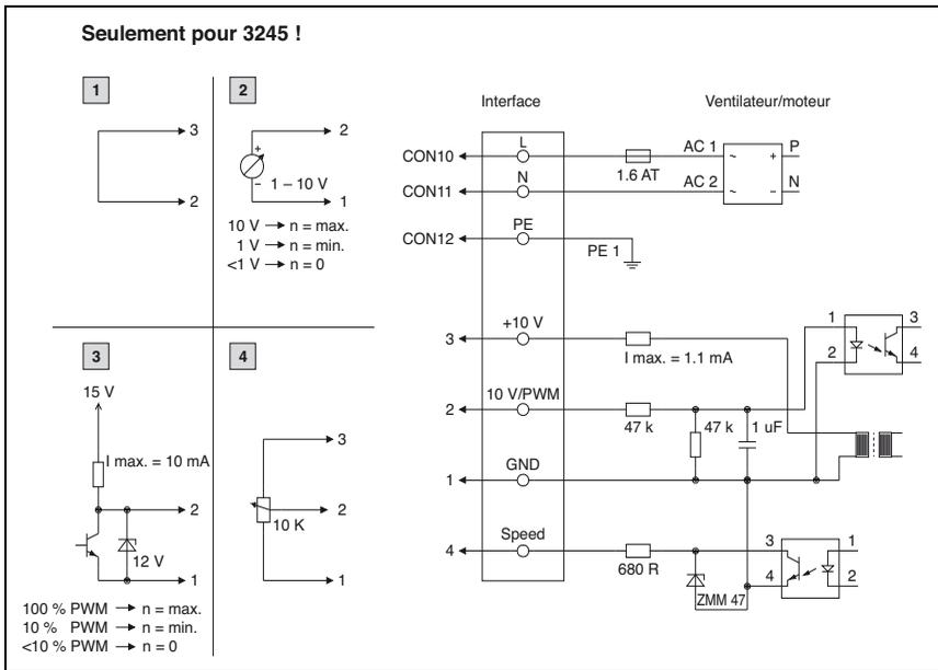
Fig. 12 : Plan de raccordement 3245
