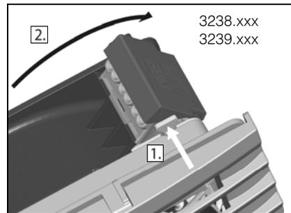
Fig. 4: Déverrouillage de la fermeture à baïonnette
